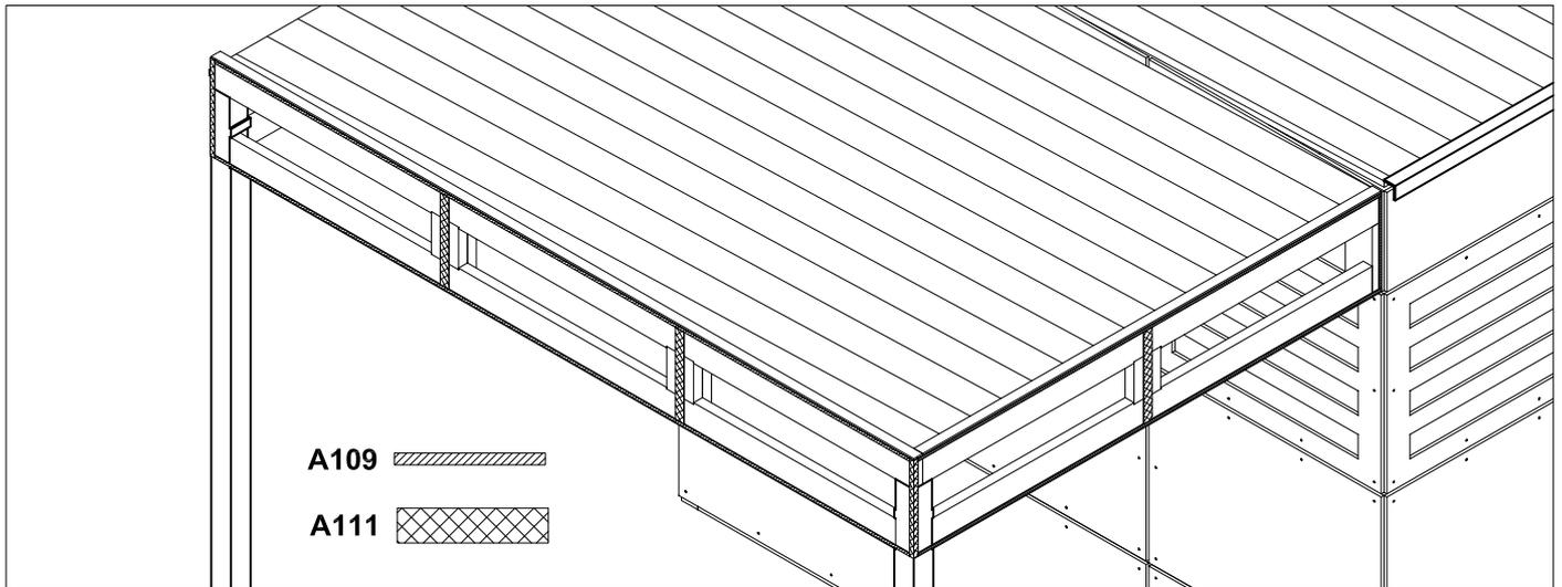
Bekleben Sie das Grundgerüst mit dem EPDM Dichtband A109 (9mm breit) und A111 (30mm breit). Verwenden Sie für die Bereiche in denen 2 Platten aneinander stoßen A111 und für die Ober- und Unterseite des Gerüsts A109. Das Dichtband muss ohne Abstand dicht auf Stoß geklebt werden um eindringendes Wasser zu verhindern. In den Eckbereichen kleben Sie das Dichtband zu gleichen Teilen um die Ecke. Halten Sie oben einen Abstand von 0,5cm bis zur Kante!
