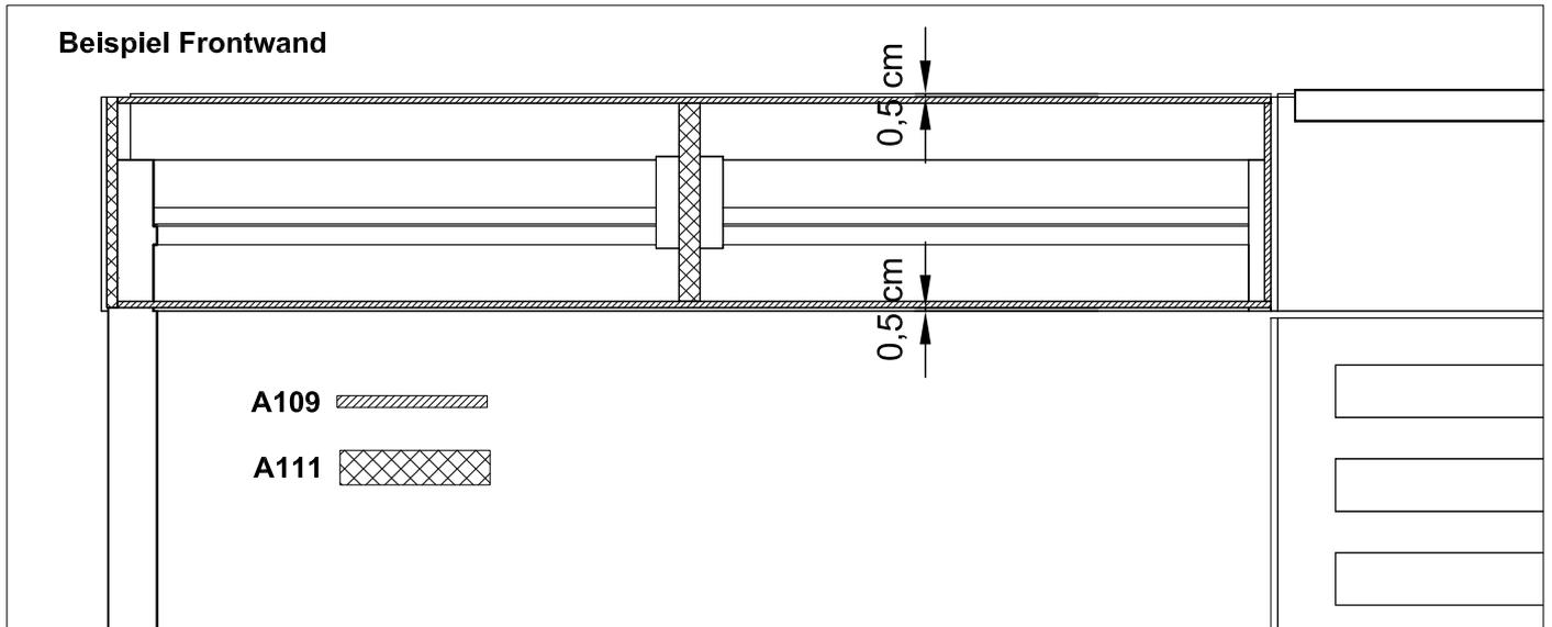
Kleben Sie das Dichtband generell genau auf Stoß um das Eindringen von Feuchtigkeit zu verhindern!
