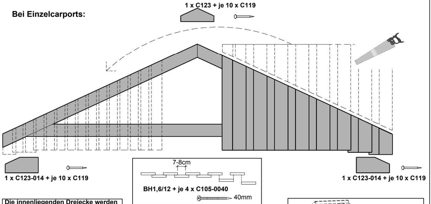
Die innenliegenden Dreiecke werden beidseitig mit den Platten befestigt.
