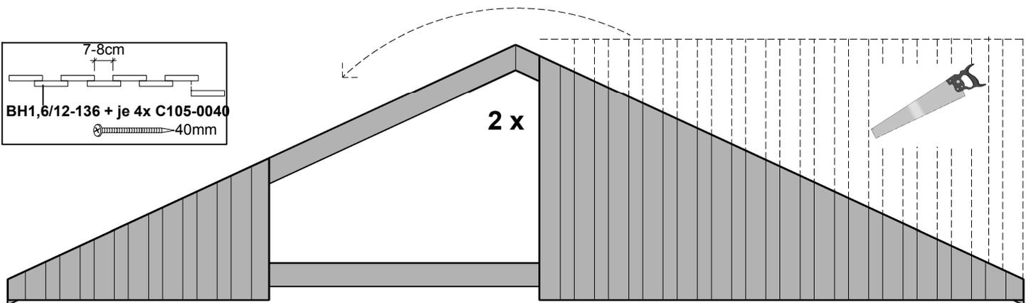
Die innenliegenden Dreiecke werden beidseitig mit den Platten befestigt.
