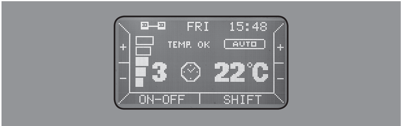
Abb. 11: Display-Anzeige bei Automatikbetrieb
