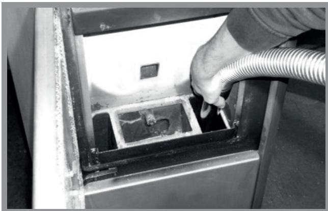
Abb. 12g: Reinigung untere Brennkammer
