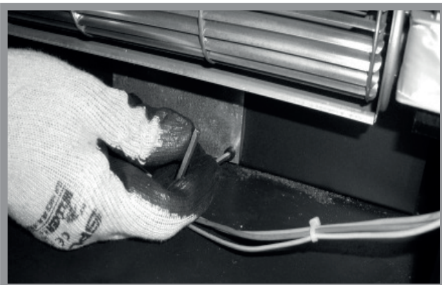
Abb. 13b: Aufschauben der inneren Abdeckplatte
