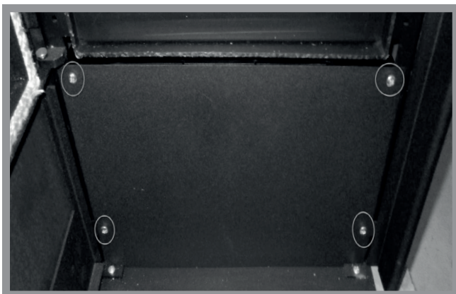
Abb. 13a: Öffnen der Frontplatte
