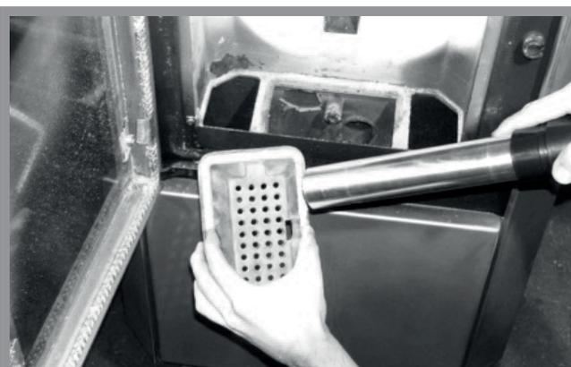
Abb. 12b: Reinigung der Luftöffnungen mit einem Staubsauger
