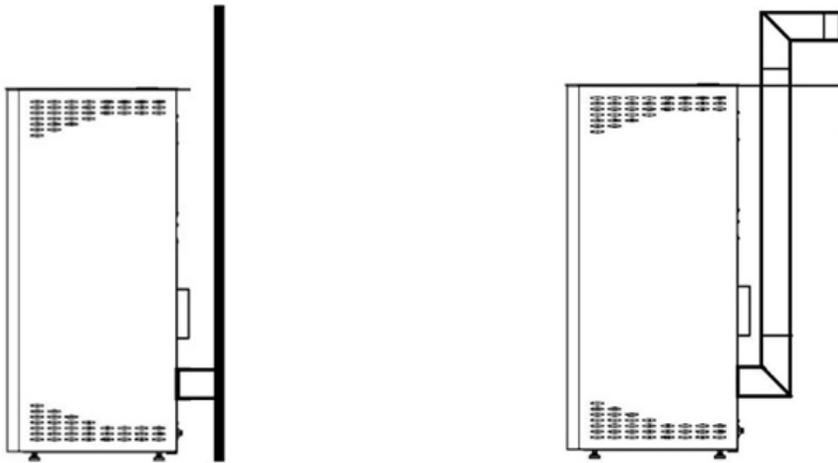
Der Anschluss an einen für feste Brennstoffe geeigneten Schornstein ist zwingend vorgeschrieben.
