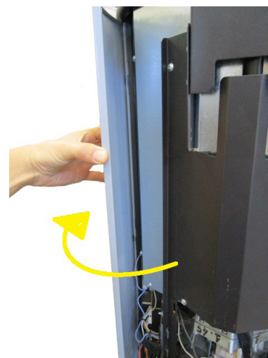
Fig. 33 - Die Platten entfernen
