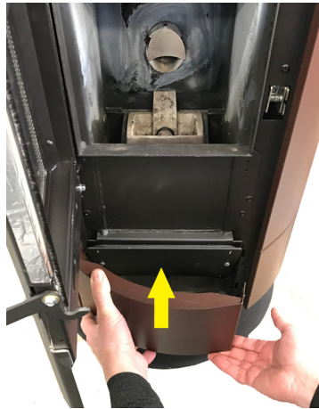
Fig. 61 - Entfernung der unteren Verkleidung
