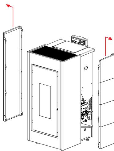
Fig. 48 - Entfernen der Seiten
