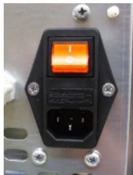
Fig. 51 - Elektrische Steckdose mit Hauptschalter
