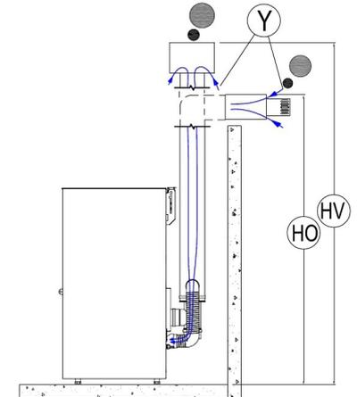
**Fig. 12 - Anschlüsse Rauchabzugsrohr****LEGENDE Fig. 11 auf S. 12 - Fig. 12 auf S. 12**
