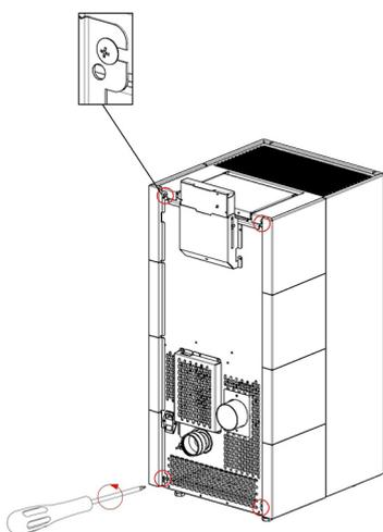
Fig. 47 - Schrauben lösen
