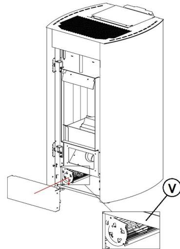
**Fig. 82 - Ventilatoren**
