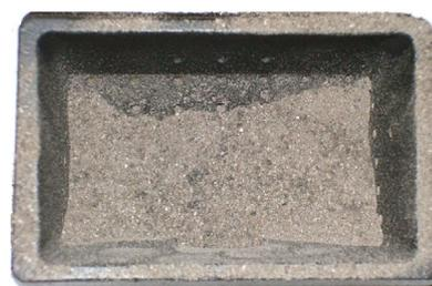
Fig. 73 - BEISPIEL VERSCHMUTZTE BRENNSCHALE
