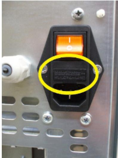
**Fig. 83 - Abdeckklappe mit Sicherungen, die ausgewechselt werden müssen**
