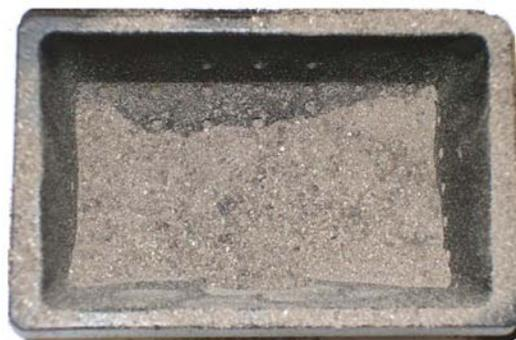
Fig. 57 - Beispiel einer schmutzigen Brennschale
