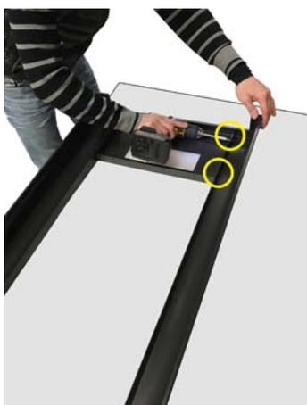
Fig. 21 - Befestigung des Trägers
