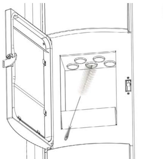
Fig. 61 - Reinigung der Rohrbündel
