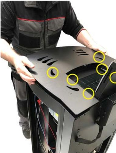
Fig. 27 - Entfernen der Abdeckung
