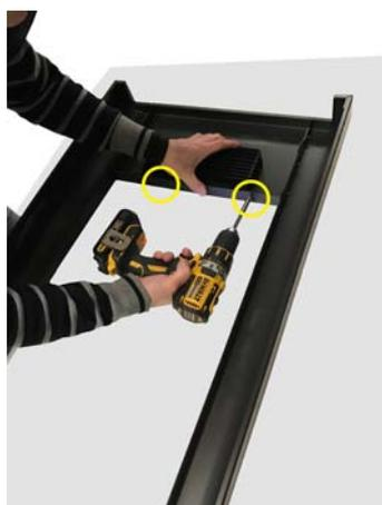
Fig. 22 - Befestigung des Gitters
