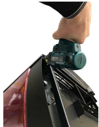
Fig. 32 - Den Ausgleich befestigen
