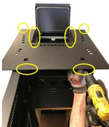
Fig. 33 - Lösen der Schrauben
