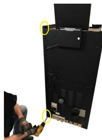
Fig. 36 - Hintere Befestigung des Seitenteils
