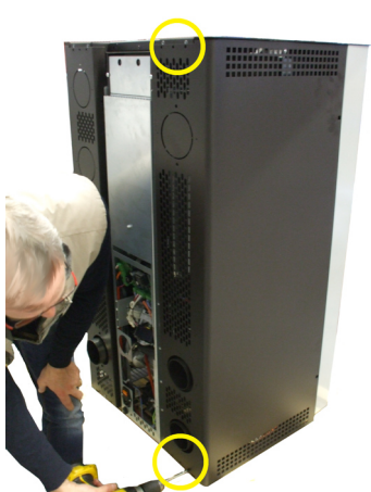
Fig. 50 - Lösen der hinteren Schraube
