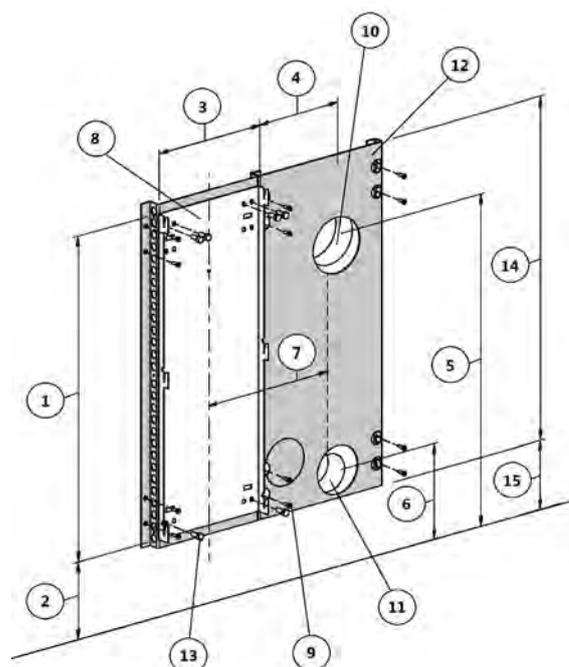
Fig. 20 - Befestigung an einer brennbaren Wand
