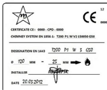
Fig. 3 - Beispiel für Typenschild
