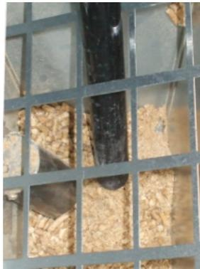
Fig. 33 - Reinigung Tank und Schnecke
