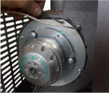
Fig. 37 - Reinigung Rauchgasansauggerät: Phase 1
