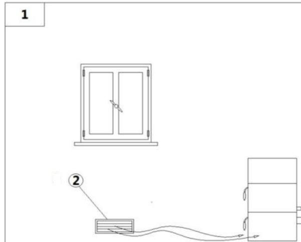
Fig. 6 - Direkte Luftzufuhr
