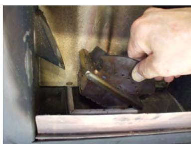
Fig. 27 - Brennschale entnehmen
