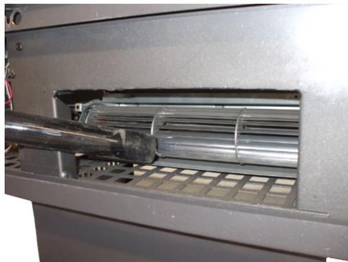
Fig. 40 - Reinigung Raumventilator
