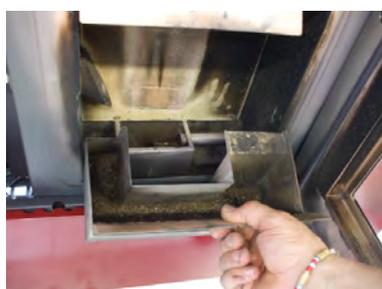
Fig. 28 - Aschenkasten entnehmen
