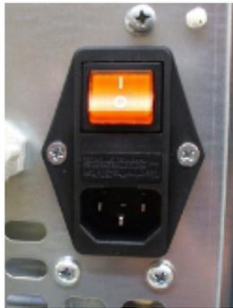
Fig. 21 - Elektrische Steckdose mit Hauptschalter
