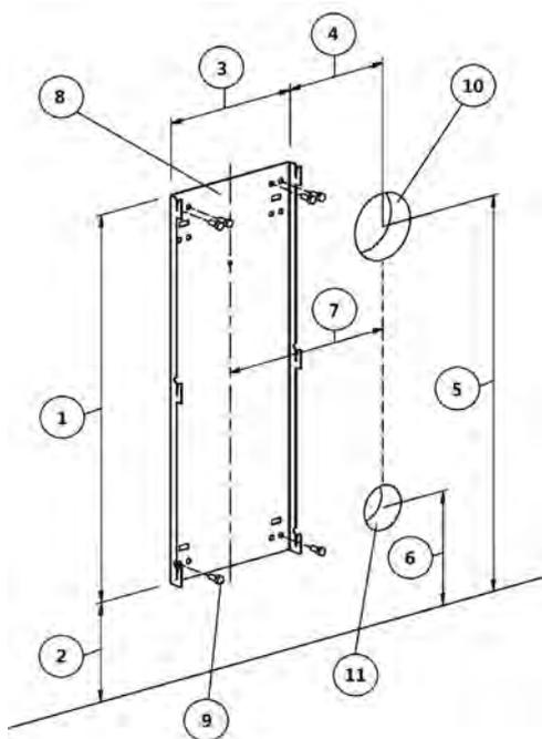
Fig. 19 - Befestigung an einer nicht brennbaren Wand
