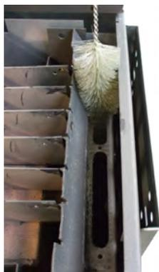
Fig. 43 - Reinigung Kanäle
