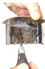
Fig. 29 - Reinigung Brennschale
