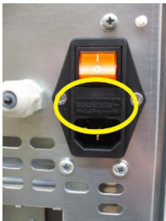
*Fig. 45 - Abdeckklappe mit Sicherungen, die ausgewechselt werden müssen*
