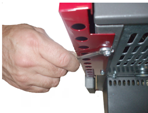
Fig. 30 - Befestigung der Platten
