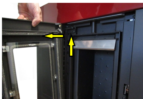
Fig. 28 - Ausbau der Tür
