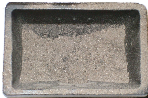
Fig. 94 - BEISPIEL VERSCHMUTZTE BRENNSCHALE
