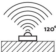
Durch die horizontale Anpassung, kann das ständige Erkennungsfeld von 120° stufenlos zur rechten und linken Seite ausgerichtet werden.
