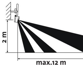
Durch die vertikale Ausrichtung, kann der Abtastbereich verringert oder erhöht werden. Lösen Sie zuerst die Feststellschraube, die das Knickgelenk in der Mitte fixiert. Drehen Sie den Sensor in die gewünschte Richtung. Der maximale Erfassungsbereich nach vorne beträgt 12 m.
