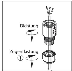
1. Lösen Sie die Verschraubung der Zugentlastung und entfernen Sie diese.
