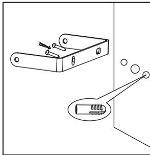
Benutzen Sie die mitgelieferten Schrauben um den Montagebügel zu montieren.
