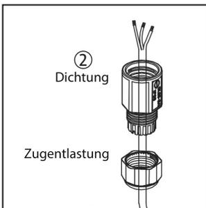
2. Lösen Sie die Verschraubung der Dichtung und entfernen Sie diese. Führen Sie das Anschlusskabel durch die Zugentlastung und darauf durch die Dichtung.
