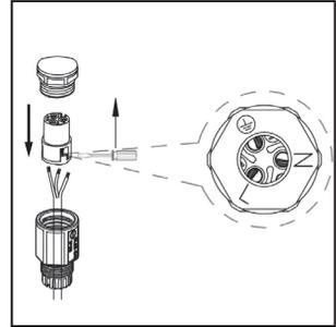
Schließen Sie die Leitungen Ihrer Netzanschlussleitung an die Anschlussklemme an und stecken die Anschlussklemme wieder auf die Leuchte.
