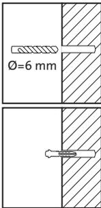
Bohren Sie 6mm-Löcher an den markierten Stellen und stecken Sie die mitgelieferten Dübel in die Bohrlöcher.
