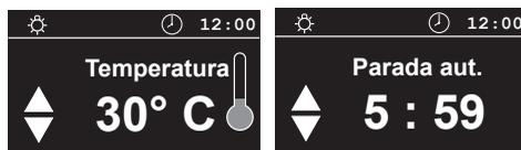
Durante la fase de calentamiento se llena el termómetro en la parte derecha de la pantalla de visualización.
