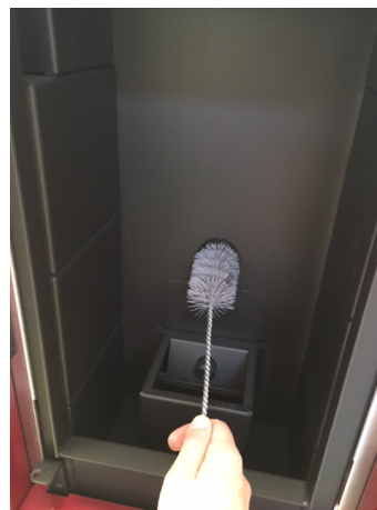
Fig. 41 - Reinigung mit Flaschenbürste
