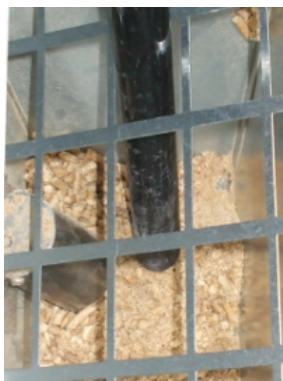
Fig. 42 - Reinigung Tank und Schnecke
