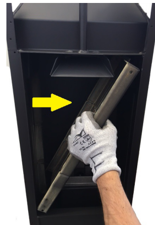
Fig. 46 - Entfernen der linken Rauchführung
