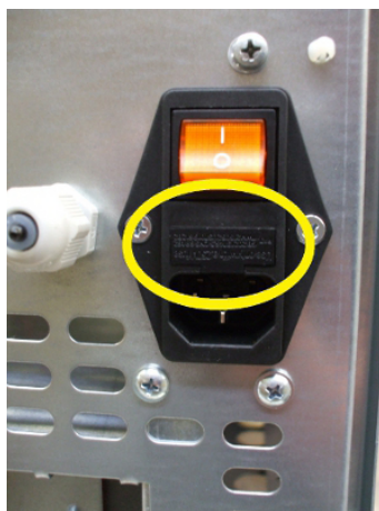
Fig. 51 - Abdeckklappe mit Sicherungen, die ausgewechselt werden müssen
