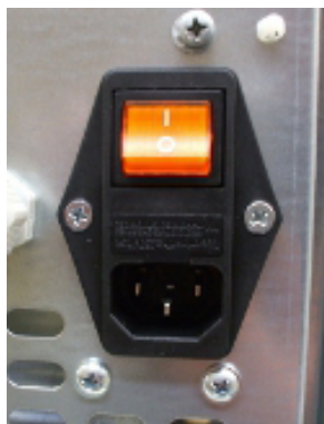
Fig. 31 - Elektrische Steckdose mit Hauptschalter
