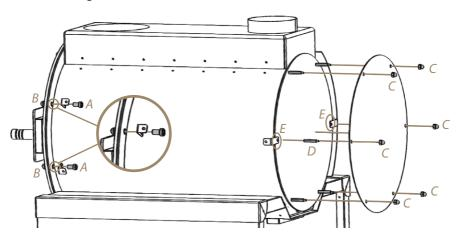
Schritt I - Befestigung der beiden Winkel an der Frontseite
