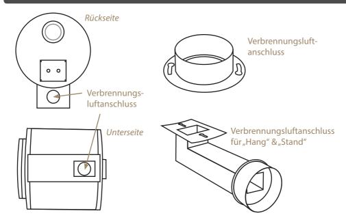
Der Kanuk Design Luto 15 kW hat hierzu einen Verbrennungsluftstutzen auf der Rückseite des Gerätes mit den Maßen 202 mm x 40 mm.
