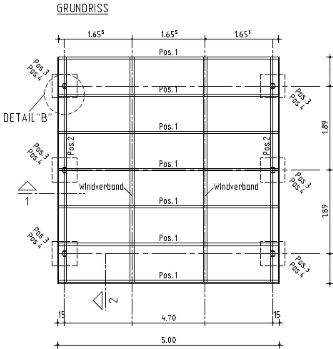
Legen Sie die Sparren auf die Tragbalken und befestigen Sie diese wechselseitig mit den HVV Winkeln, die Sie wiederum mit Spax-Schrauben 4x30 mm befestigen (siehe Skizze Nr. 2).
