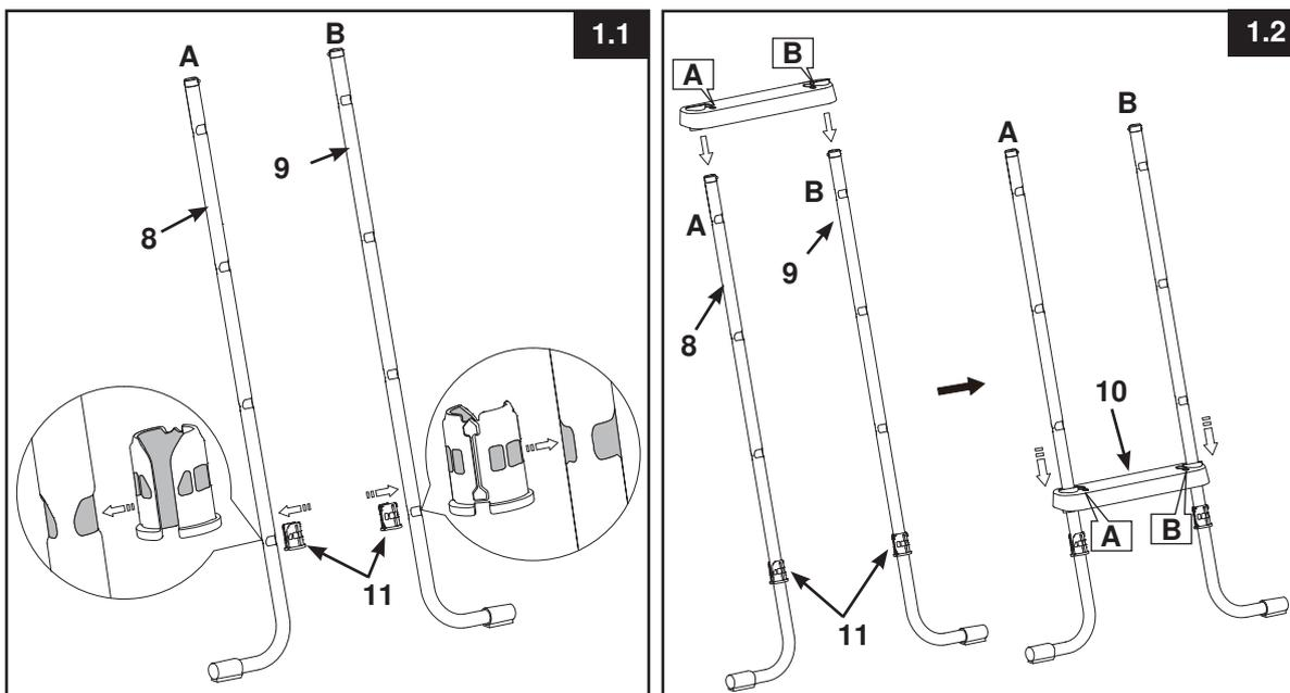
**WICHTIG:** Versichern Sie sich, dass die J-förmigen FüÙe nach auÙen schauen, bevor Sie die Stufen montieren.
