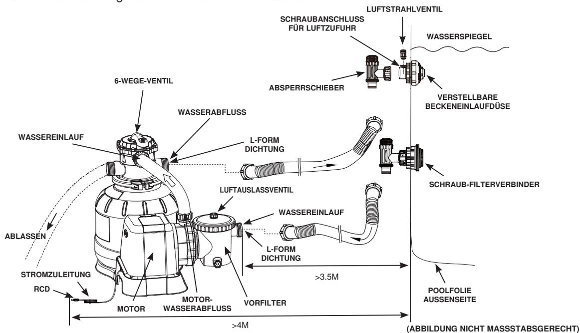
Nach Angaben der internationalen Norm IEC 60364-7-702 müssen vom elektrischen Gerät zu Schwimmbädern und anderen Becken Ausrüstungen folgende Distanzen eingehalten werden.
