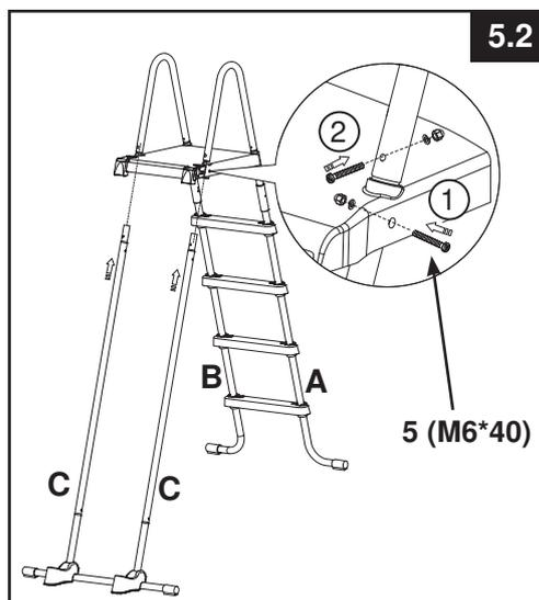
**WICHTIG:** Bauen Sie die Leiter Seite für Seite zusammen. Verbinden Sie die zwei Seiten nicht, bevor die U-förmigen Handläufe montiert sind. Versichern Sie sich, dass alle Muttern und Bolzen sicher und fest angezogen sind. Die Schrauben sollten Sie erst dann fest anziehen, wenn die Leiter komplett zusammengebaut ist.
