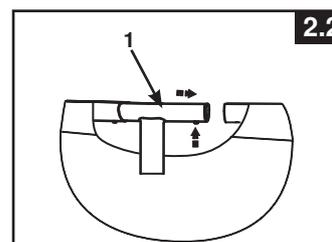
Die letzte Verbindung kann schwer zu bewerkstelligen sein. Es geht jedoch leichter, wenn Sie zuerst das letzte Verbindungsstück und die Stange gleichzeitig um ca. 5 cm anheben. Nun stecken Sie die Stange ins Verbindungsstück während Sie die Teile absenken. Die Stange wird leicht ins Verbindungsstück gleiten (siehe dazu Zeichnung 2.3). Bevor Sie mit dem Zusammenbau der Steher weitermachen, vergewissern Sie sich, dass das letzte Verbindungsstück vollständig zusammengesteckt ist.
