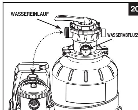
2. Geben Sie eine L-Form-Dichtung (11) auf den Einlaufstutzen des 6-Wege-Ventils und an den Abfluss des Pumpenmotors. Befestigen Sie im Uhrzeigersinn den Sandfilter-Verbindungsschlauch (13) zwischen dem Pumpenmotorabfluss und dem Einlaufstutzen des 6-Wege-Ventils (siehe dazu Zeichnung 21).
