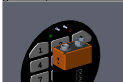
Bild 2. Kontakte zur Notbestromung
