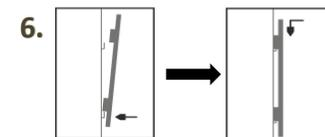
6. Das Heizpaneel ist nun in die montierte Montagespange einzuhängen.
