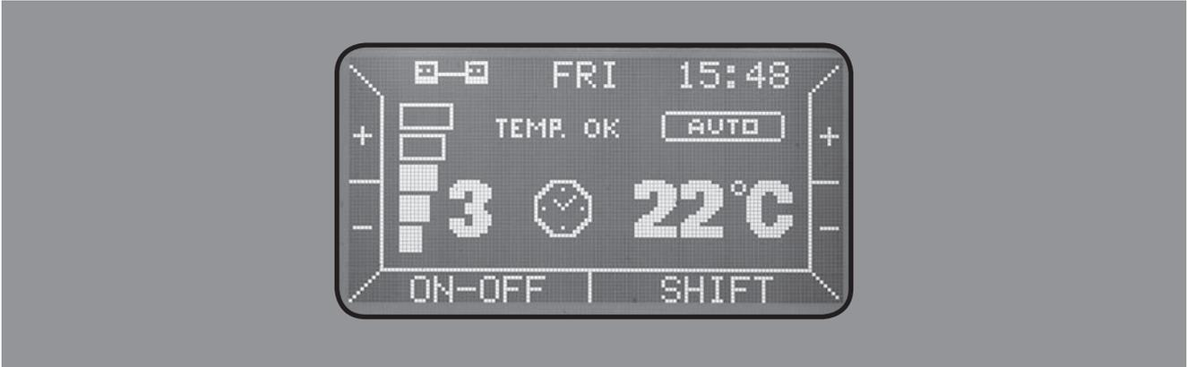
Abb. 10: Display-Anzeige bei Automatikbetrieb
