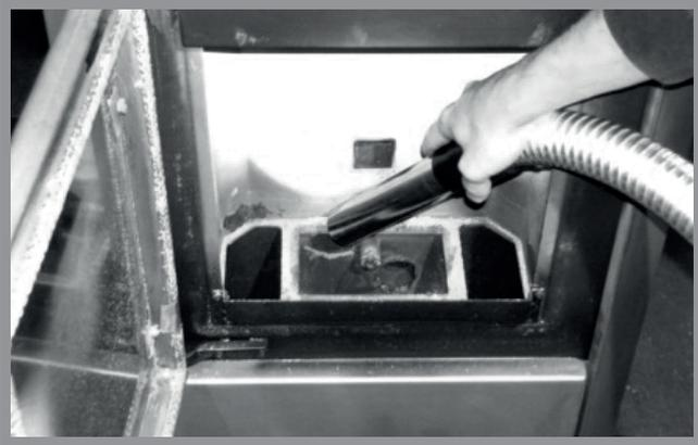
Abb. 12d: Reinigung der Topfhalterung
