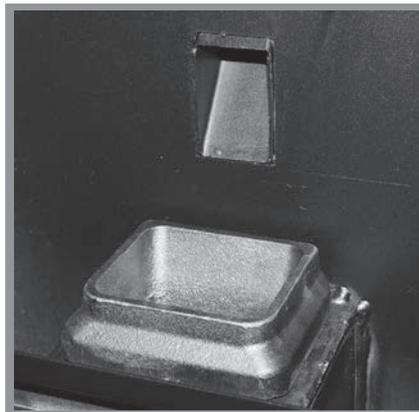
Abb. 5b: Richtig eingesetzter Brenntopf
