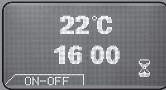
Abb. 6: Display-Anzeige während der Abkühlphase
