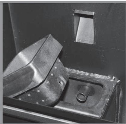
Abb. 5a: Brenntopf einsetzen
