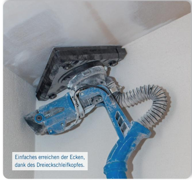
Einfaches Erreichen der Ecken, dank des Dreieckschleifkopfes.
