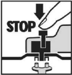
Um die Scheibe anzubringen, halten Sie die Spindelarretierung kontinuierlich tief eingedrückt. Drehen Sie die Spindel gegebenenfalls etwas mit der freien Hand, bis sie einrastet.
