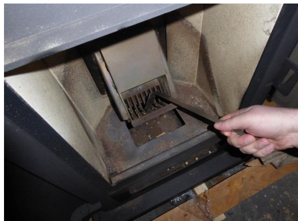
Reinigung der Lamellen des Pelletbrenners mit dem Kratzer nach dem Ausbau der Auskleidung des Brennraums .
