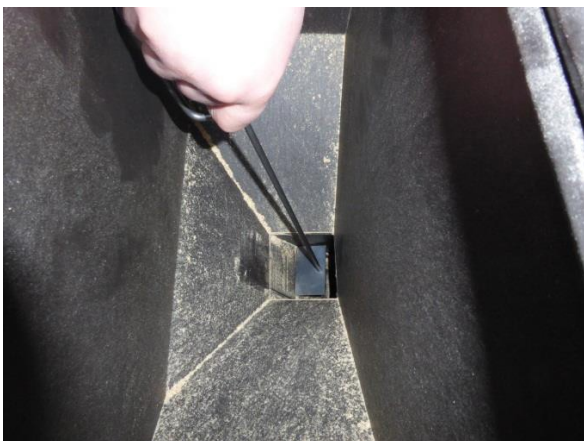
Reinigung des Pelletkanals mit dem Reinigungswerkzeug durch Kratzen vom oberen Rand des Kanals bis zum Brennkorb.
