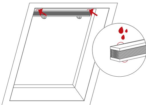
**3** Befeuchten Sie die Saugnäpfe zur Verbesserung der Hafteigenschaft. Positionieren Sie das Plissee zunächst mit den oberen beiden großen Saugnäpfen an gewünschter Position.
