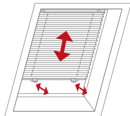
**4** Plissee auf gewünschte Länge herunterziehen und mit den beiden unteren Saugnäpfen an der Glasscheibe fixieren. Die Saugnäpfe können beliebig oft versetzt werden, um die Höhe des Plissees zu ändern.
