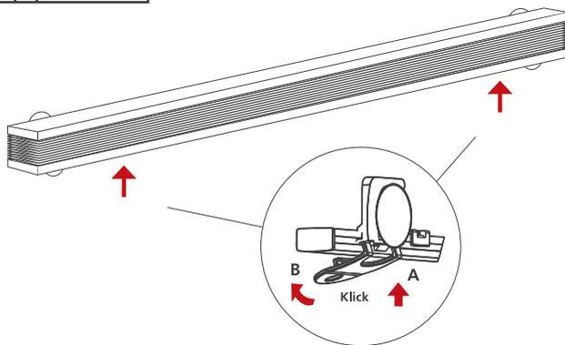
**1** Bediengriffe auf die untere Schiene stecken (die Schiene mit den kleineren Saugnäpfen).
