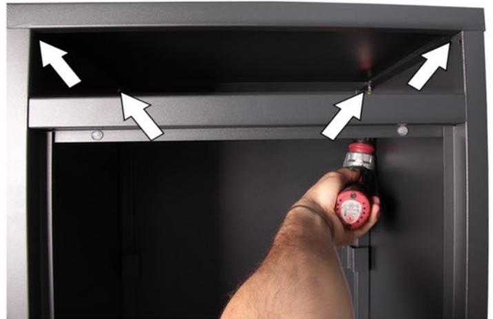
Setzen Sie den Deckel (5) wie dargestellt auf. Achten Sie darauf, dass die doppelte Umkantung auf der Front sitzt und die einfache Umkantung die Rückwand abschließt. Verschrauben Sie anschließend den Deckel, mit den Seitenwänden an den gekennzeichneten Stellen.
