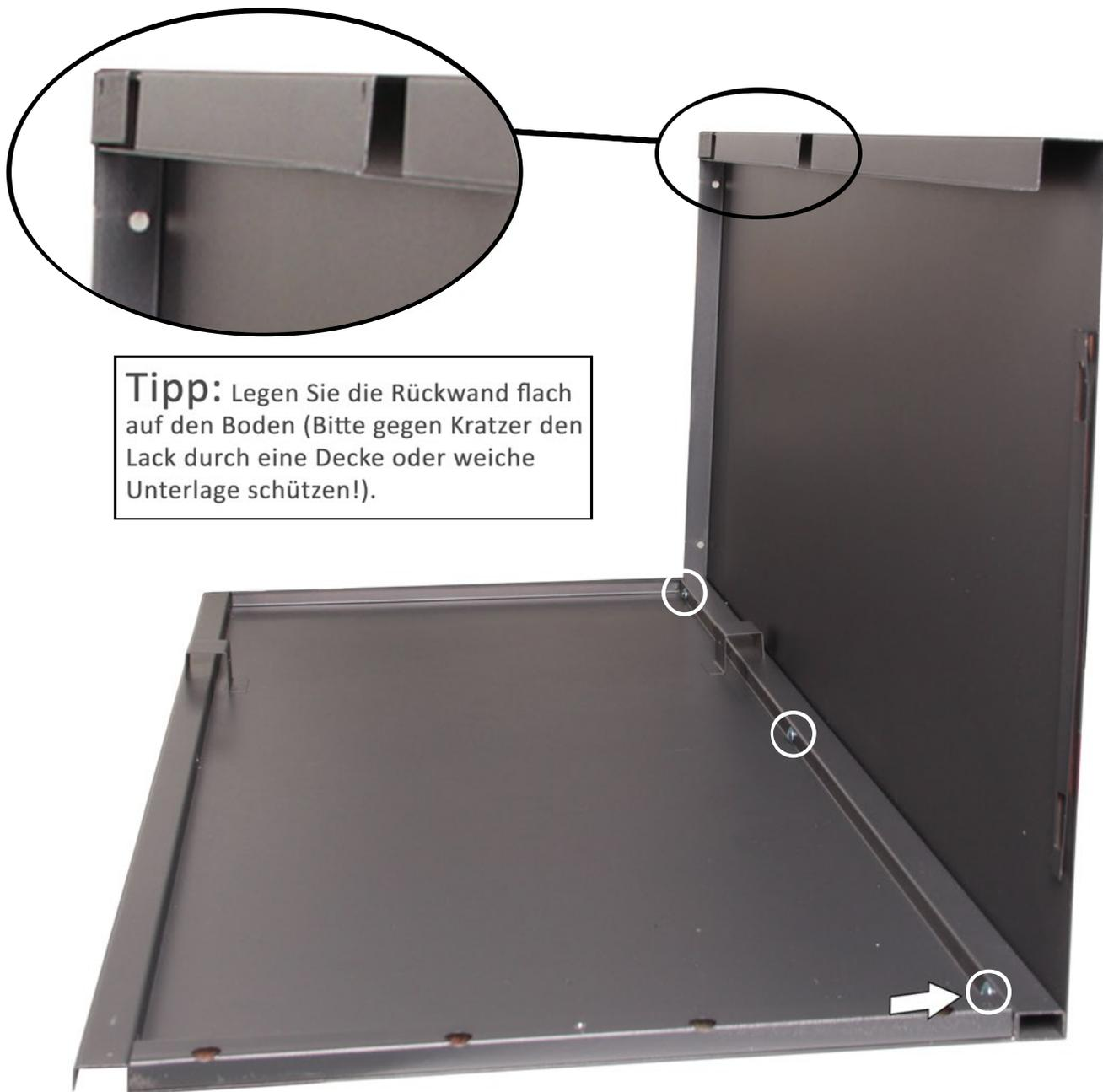
Führen Sie die lange gewinkelte Seite der Seitenwand 2 (2) von unten in die lange gewinkelte Seite der Rückwand (3), sodass die 3 Schraubenlöcher übereinander liegen. Verschrauben mit 3 Schneidschrauben (16) die Rückwand (3) mit der Seitenwand (2).
