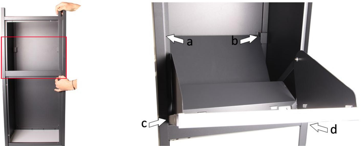
Führen Sie die Scharnierstifte (a, b) der Innenblende (9) in die dafür vorgesehenen Bohrungen der Rückwandhalterungen ein. Führen Sie anschließend die Scharnierstifte (c, d) der Frontblende (8) in die dafür vorgesehenen Bohrungen der Seitenwände (1, 2) ein. Überprüfen Sie vorher, dass sich die Scharnierstifte bewegen lassen. Durch die Lackierung können die Scharnierstifte unter Umständen etwas schwer gangbar sein.
