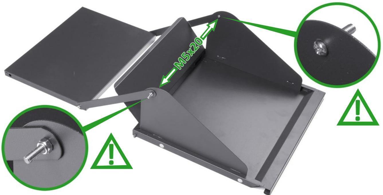
Fügen Sie die Innenblende (9) und die Frontblende (8) mit den Verbindungsstreben (10) und den Schraubensets (14, 15) wie dargestellt zusammen. Achten Sie darauf, dass die **Schraubenköpfe nach innen** zeigen!
