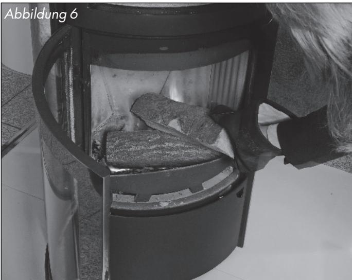
Sind auch diese Holzstücke rundherum angebrannt, sollten Ofen und Abgassystem weitgehend die Betriebstemperatur erreicht haben. Jetzt können Sie den Primärluftregler schließen und die Verbrennung hauptsächlich über den Sekundärluftregler regeln (Abb. 7).
