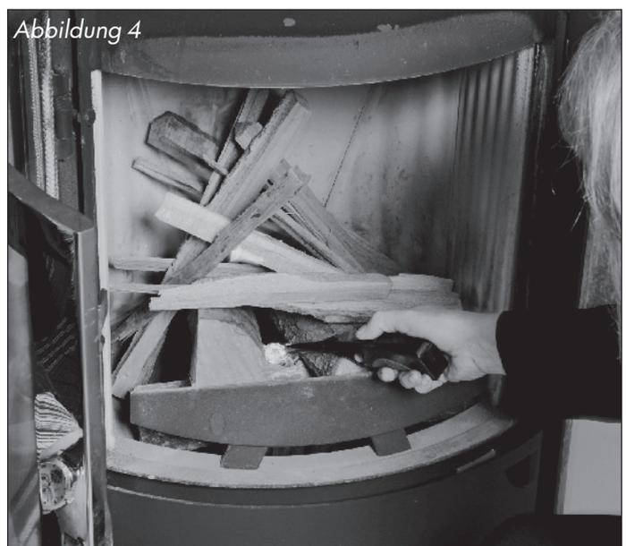
Lassen Sie diese Holzaufgabe mit geöffneten Verbrennungsluftreglern herunterbrennen, bis eine Grundglut vorhanden ist (Abb. 5). Je nach Holzgüte, Schornsteinzug und Witterung dauert diese Verbrennungsphase unterschiedlich lange. Legen Sie jetzt zwei weitere Holzscheite parallel zur Feuerraumscheibe auf und verschließen die Feuerraumtür (Abb. 6).
