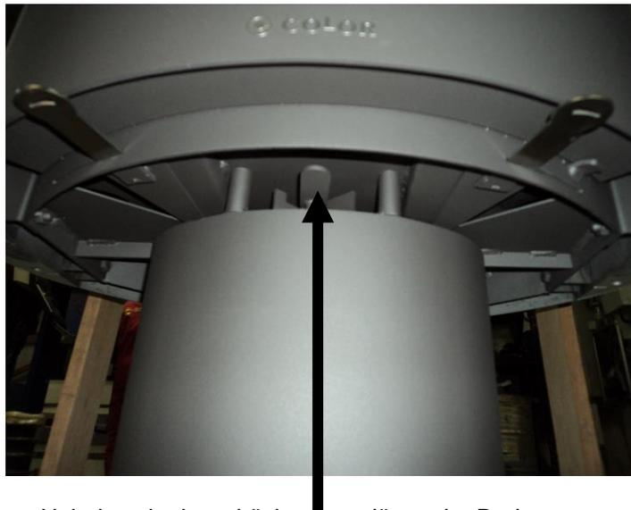
Hebel nach oben drücken zum lösen der Drehsperre.
