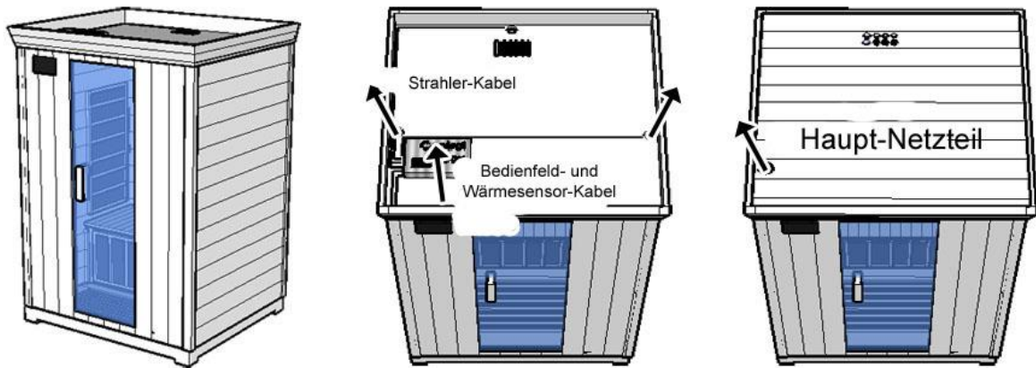
Bild A6: Deckelplatte und Kabelverbindungen
