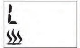
Betätigen Sie OK, um die L-Temperatur zu ändern; die Standardeinstellung ist 10°C. Diese Temperatur können Sie nun mittels der Tasten + und - umstellen. Bestätigen Sie mit OK.
