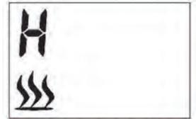
Betätigen Sie OK, um die H-Temperatur zu ändern; die Standardeinstellung ist 10°C. Diese Temperatur können Sie nun mittels der Tasten + und - umstellen. Bestätigen Sie mit OK.
