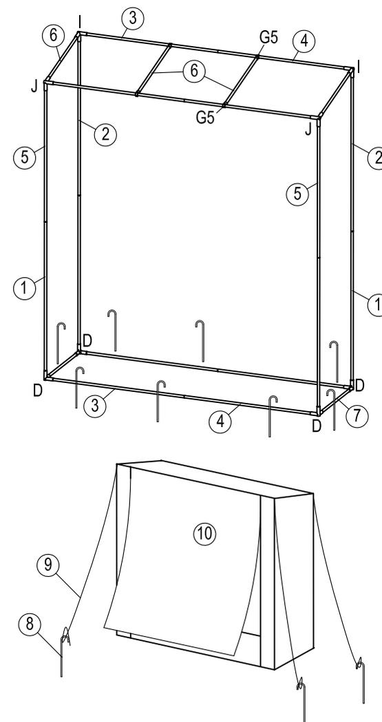
Der Reißverschluss muss geöffnet werden, bevor Sie die Plane über das Gestänge legen und befestigen. Auf diese Weise ist es einfacher die Plane auf das Gestänge zu legen und Sie vermeiden eventuelle Beschädigungen an der Plane.
