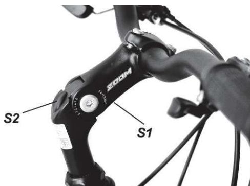
Abbildung 4. Lenkermontage: Steckvorbau mit variabler Winkeleinstellung (S1) Cityfahrrad
