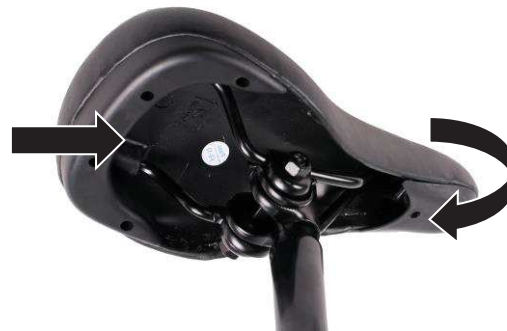
Abbildung 12. Sattel mit Sattelkerze und Sattelschnecke
