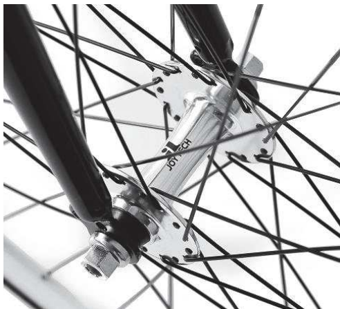
Abbildung 16. Vorderrad ohne Schnellspanner (Ausführung Fixie, Rennrad)
