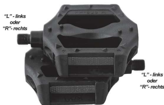
Abbildung 27. Pedale mit "R"- "L" - Positionsbezeichnung
