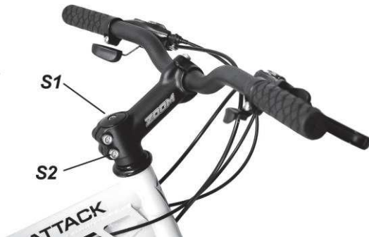
Abbildung 2. Lenkermontage: AHEAD-Vorbau MTB, Rennrad
