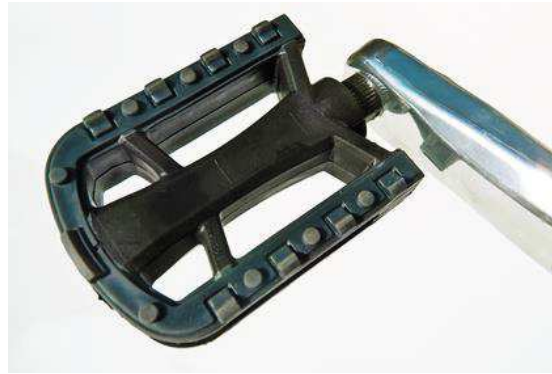
Abbildung 28. Richtige Pedalmontage bis zum Tretkurbelansatz
