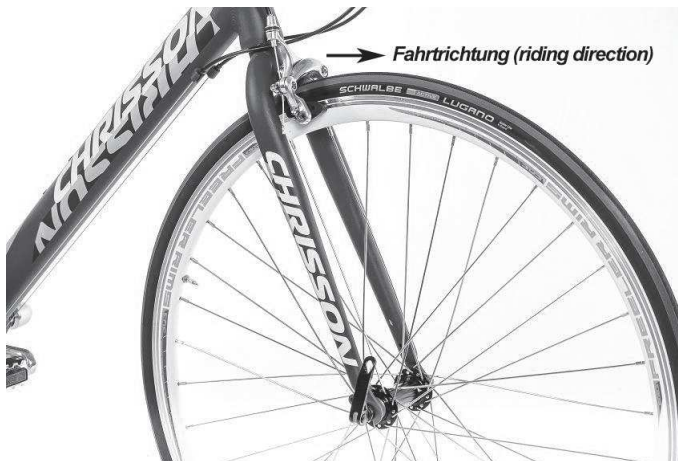
Abbildung 1. Gabel in Fahrtrichtung umdrehen
