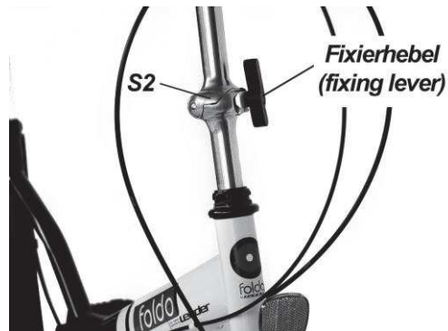
Abbildung 7. Lenkermontage: faltsteckvorbau Faltrad
