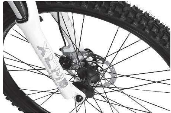
Abbildung 18. Einsatz des Vorderrades bei Scheibenbremsen
