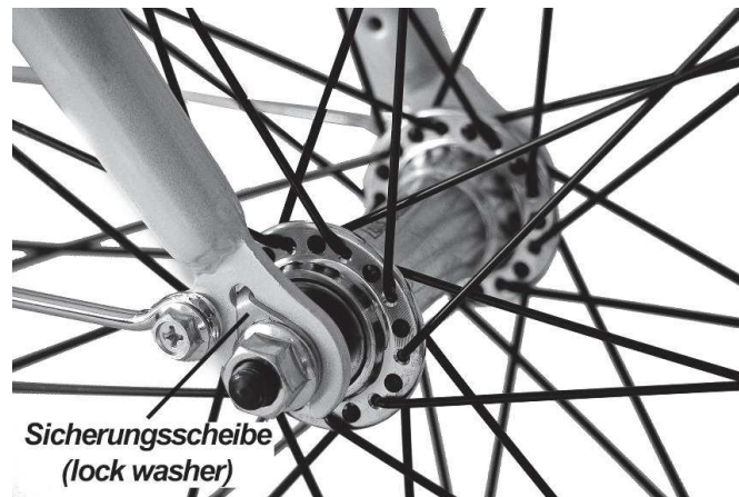
Abbildung 17. Vorderrad ohne Schnellspanner mit Sicherungsscheiben
