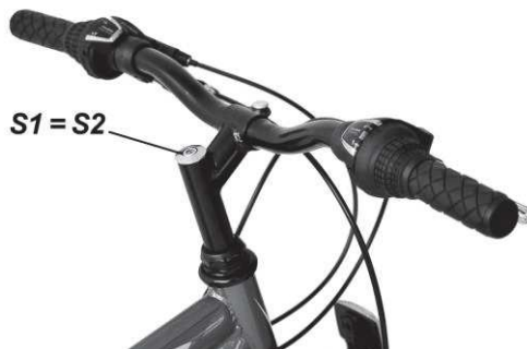
Abbildung 6. Lenkermontage: Steckvorbau Kinderfahrrad
