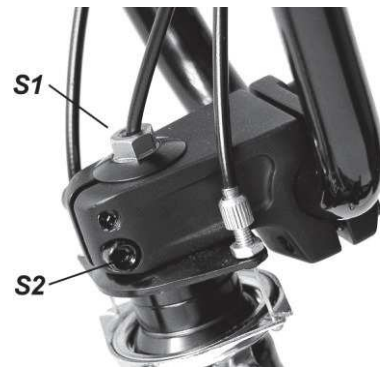
Abbildung 3. Lenkermontage: AHEAD-Vorbau BMX-Rad
