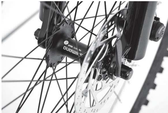
Abbildung 18. Einsatz des Vorderrades bei Scheibenbremsen
