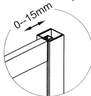
ACHTUNG!! Das Glas des Seitenteils steht etwa 10 mm in das Halteprofil hinein. Beachten Sie unbedingt beim Einsetzen der Schraube, dass diese mindestens 12 mm vom Halteprofil des SEITENTEILS weg versetzt wird, da Sie andernfalls das Glas beschädigen würden!!!
