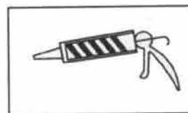
Zur Herstellung der Dichtigkeit spritzen Sie den Übergang der Wandanschluss-Profile zur Wand mit Silikon ab. Hierzu muss der Untergrund trocken und frei von Staub und Schmutz sein. Andernfalls haftet das Silikon nicht entsprechend. Bitte beachten Sie in diesem Zusammenhang die Verarbeitungshinweise des Silikon-Herstellers auf der Silikon-Kartusche.
