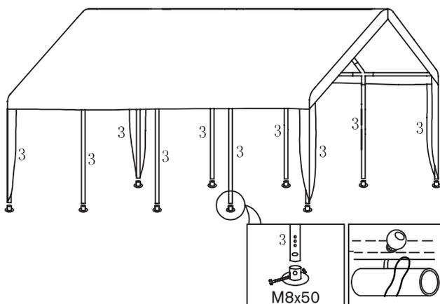
**Tip:** Stecken Sie zunächst die vier äußeren Standrohre und im Anschluss die restlichen Standrohre in die Verbinder.
