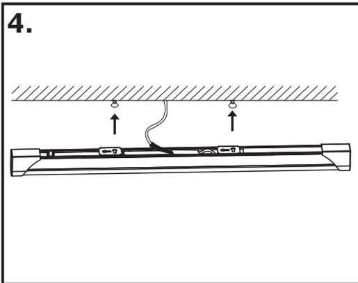
Nun schieben Sie die Leuchte mit den Befestigungslöchern auf die Schrauben in der Wand/Decke. Mit einer seitlichen Bewegung wird die Leuchte dann arretiert, wobei sich die Schraubenköpfe von der breiten Öffnung in die schmale Öffnung verschieben. Achten Sie darauf, dass das Kabel sorgfältig in der Leuchte verstaut ist.
