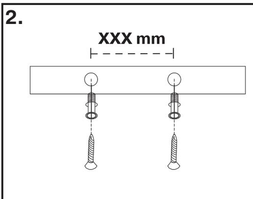
Bohren Sie zwei Löcher (Durchmesser: 6 mm, Tiefe: 30 mm) in dem zuvor abgemessenen Abstand.
