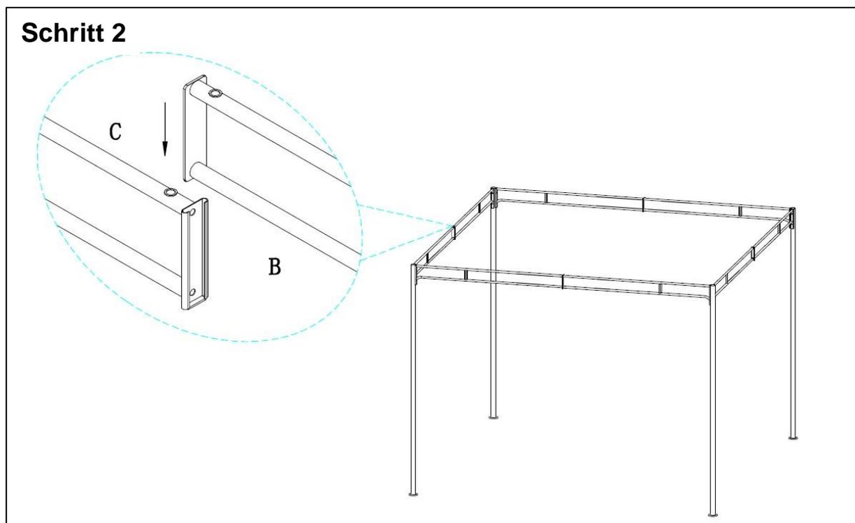
Danach stecken Sie die Strebe B in die Nut der Strebe C. Auch hier bei allen 4 Seiten. Dazu stellen Sie das Gestänge am besten auf den Kopf.
