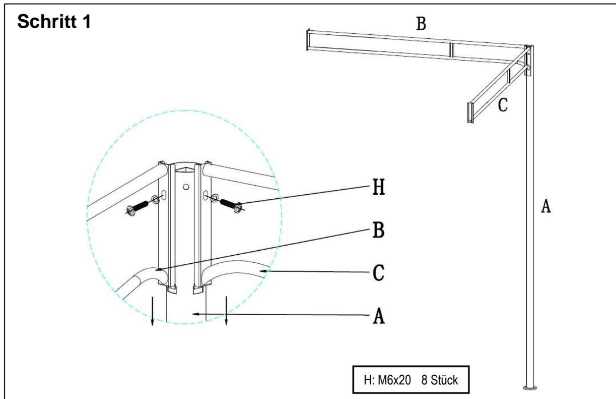
Stecken Sie die Streben B und C in die Laschen des Standbeines A und sichern Sie diese Verbindung mit den Schrauben. Das wiederholen sie an allen Beinen.
