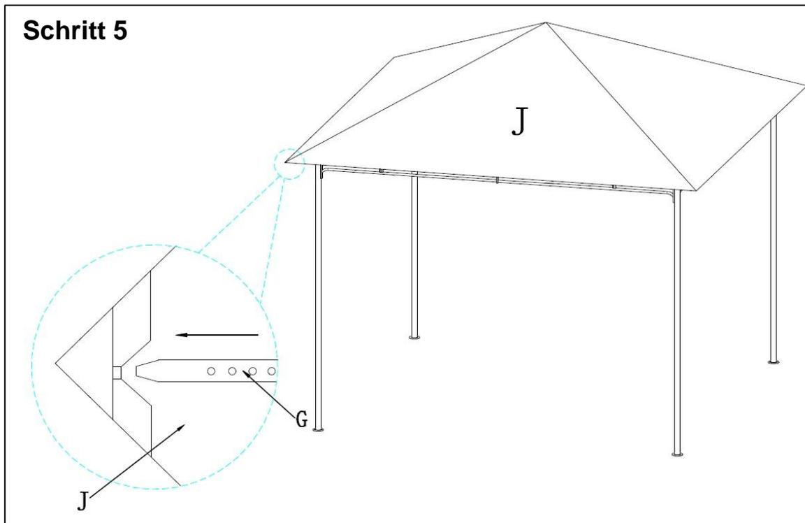
Legen Sie den Dachbezug J über das Gestell. Die Spanner G führen Sie in die Tasche an den Ecken des Bezuges. Mit gleichmäßigem Herausziehen der Spanner und gleichzeitigem Einrasten der Federclips spannen Sie den Bezug über das Dach.
