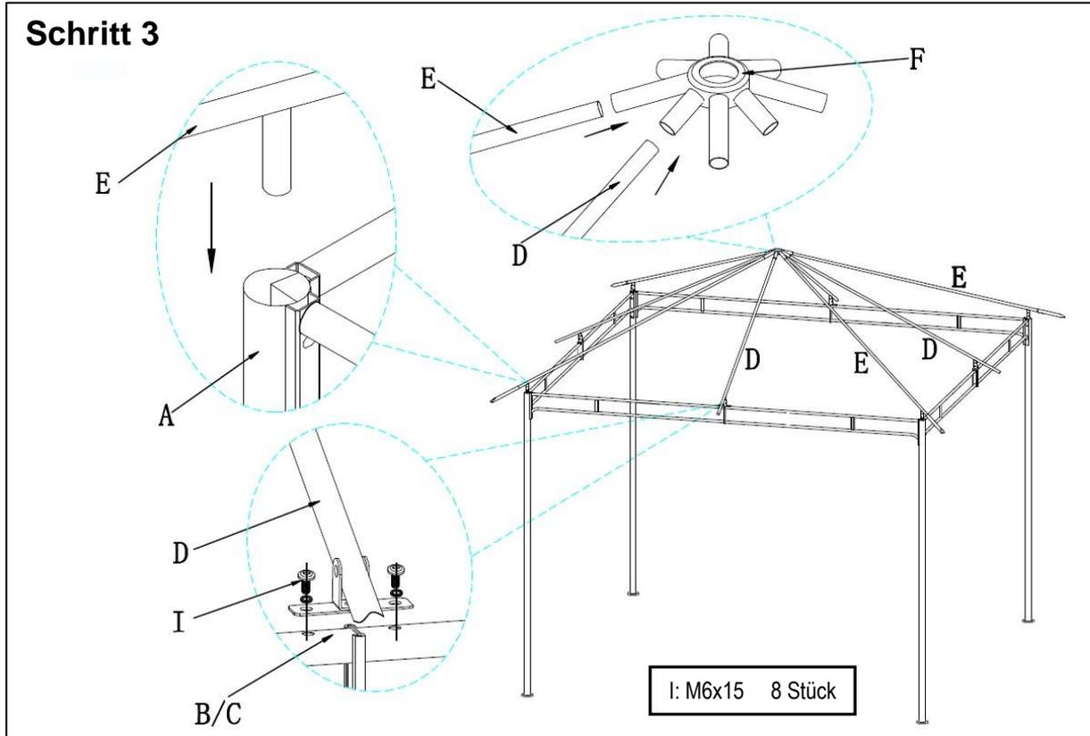
Stecken Sie die (längeren) Ecksparren E oben in die Standbeine und in das längere Rohr des Sparrenverbinders F.
