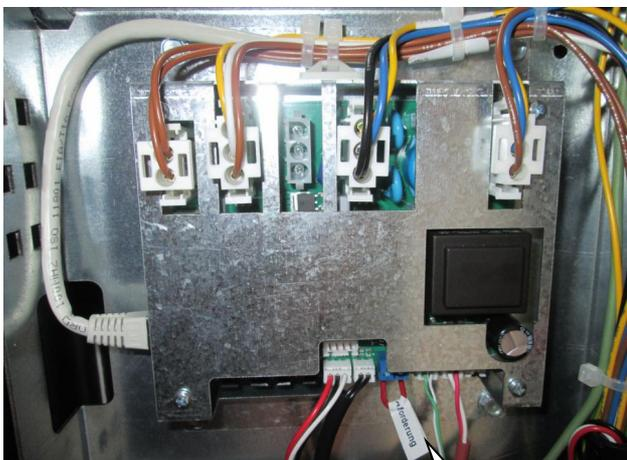
Durch entfernen der rechten Seitenverkleidung wird die Regelplatine sichtbar. Dort ist die Kabelbrücke „externe Anforderung“ sichtbar. Diese, falls notwendig, durch einen externen potentialfreien Schaltkontakte ersetzen.
